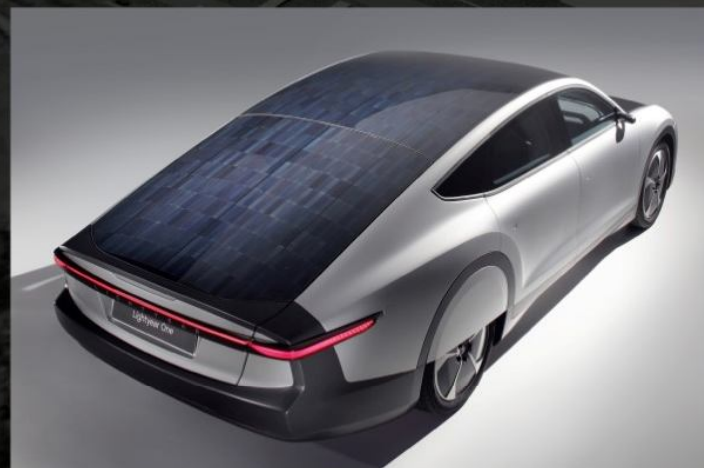
Achteraanzicht van de Lightyear One. De gehele bovenkant is voorzien van 5 m 2 veiligheidsglas zonnepanelen, sterk genoeg om er overheen te kunnen lopen.
