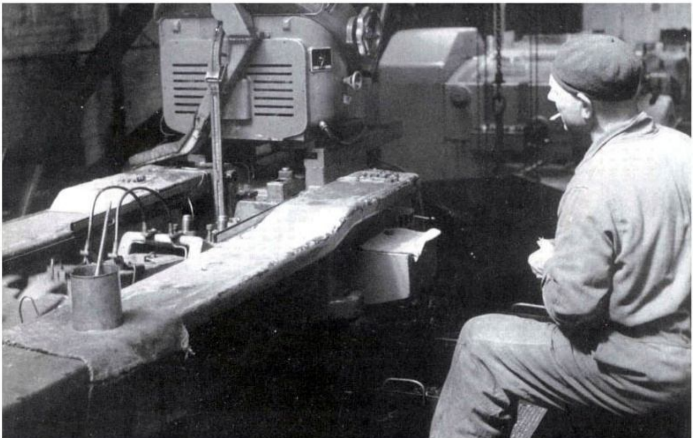
De controleur houdt de gemechaniseerde moerentapmachine in de koudperserij van de fabriek van Everts & van der Weyden in de gaten.
